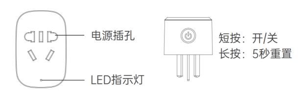
指示灯关闭:断电状态蓝灯闪烁:初始配置中
