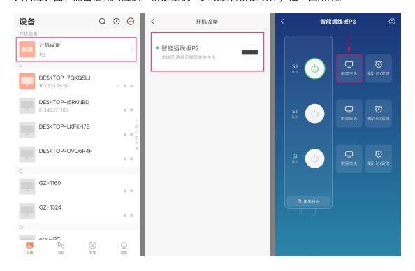
点击"绑定主机"之后,在主机列表中选择想要绑定的主机设备,并在提示框中点击"确定", 即可将主机设备与插线板指定的插孔绑定起来。
